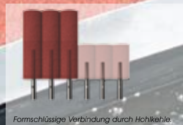
Formschlüssige Verbindung durch Hohlkehle.
